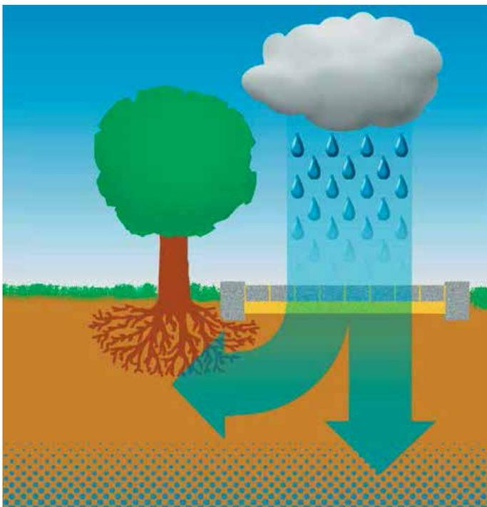
Versickerungsfähige Oberflächen reduzieren den oberflächlichen Abfluss an Regenwasser
