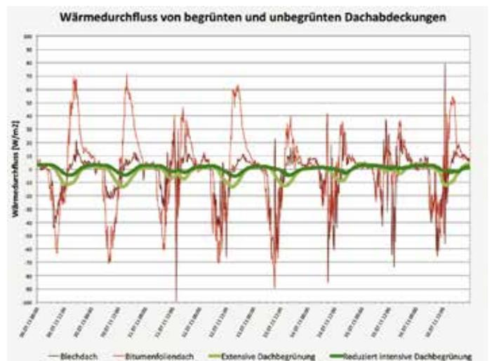
*Die Wirkung der intensiven und der extensiven Dachbegrünung:
